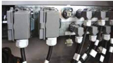
Tutte le spine per l'aviazione sono dotate di protezione da acqua e polvere
